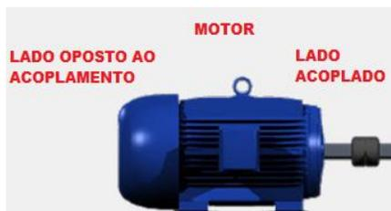
Em cada um desses pontos, a coleta é feita no **SENTIDO HORIZONTAL** e **VERTICAL**. Em um desses pontos, escolhemos também a medida na direção **AXIAL**.
