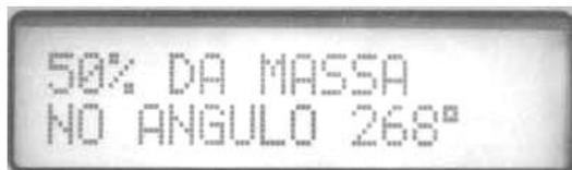
Por exemplo: 50% da massa de teste no ângulo 268° significa: Adicione metade da massa de teste a 268° da posição da massa de teste, no **sentido contrário** à rotação do rotor.
