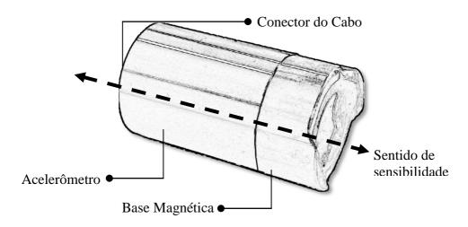
O acelerômetro possui estrutura de aço e um circuito eletrônico interno para amplificar o sinal captado. Sua fixação pode ser feita através de base magnética ou parafusado em rosca M8. A sua resposta é linear na faixa de 5Hz a 10KHz, com ressonância em torno de 20KHz.
